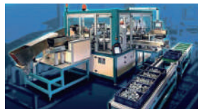
Eine von uns vor Ort beim Kunden verkabelte und in Betrieb genommene Sortiermaschine
